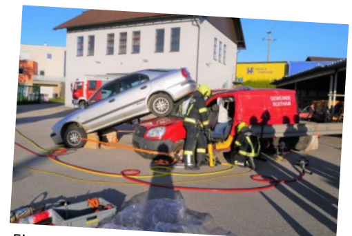
Einsatz des Rettungszyinders bei einer Übung des Technical Rescue Teams (TRT)
